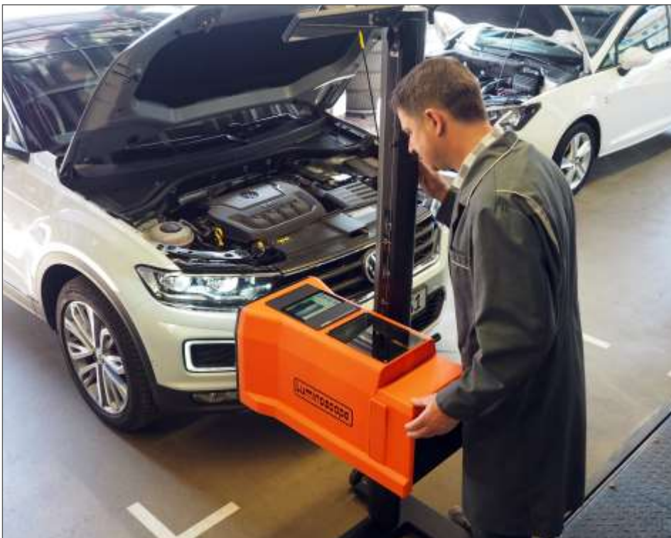
Digitales Scheinwerfer-Einstell-Prüfgerät (SEP) mit automatischem Nivellierausgleich
